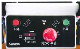
昇降スイッチ(赤・緑) バッテリー残量ゲージ 非常停止ボタン
